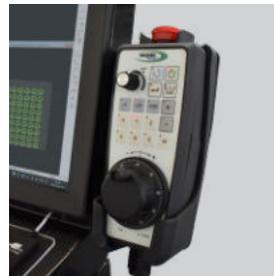
Das MPG ermöglicht es, manuell vor-/rückwärts auf der Schneidbahn zu fahren. So kann man den exakten Punkt auf einem Schneidweg finden, an dem er nach einem Stop mit dem Schneiden fortfahren oder ein vorgeschchnittenes Teil lokalisieren kann.
