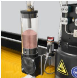
Tech-Sense™ Monitoring System ermöglicht einen wirklich unbewachten Betrieb. Nach einer Unterbrechung des Schneidprogramms kann es einfach fortgesetzt werden. Mit unserer variablen Abrasivdosierer wird die Zufuhr über die Software eingestellt.
